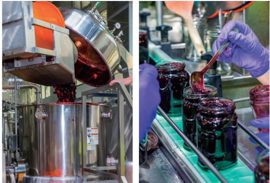
桑椹在挑揀台上，工作人員以目視方式進行雜質辨別，檢出落葉、枝梗後（上圖），放入真空煉煮機熬煮（左圖），最後以人工充填及補充果粒，讓消費者能品嚐到飽滿又完整的桑椹果粒醬（右圖）。
